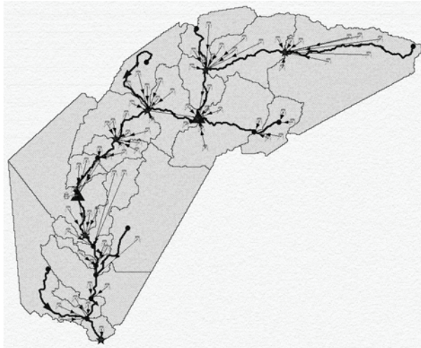
Obr. 3 Ukážka spracovania povodia Hronu v MIKE BASIN – uzly a bodové zdroje znečistenia
